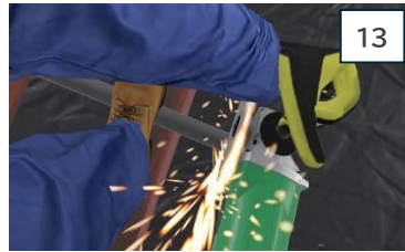
グラインダー使用中の火傷
