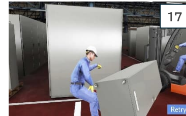
フォークリフトの荷崩れ
